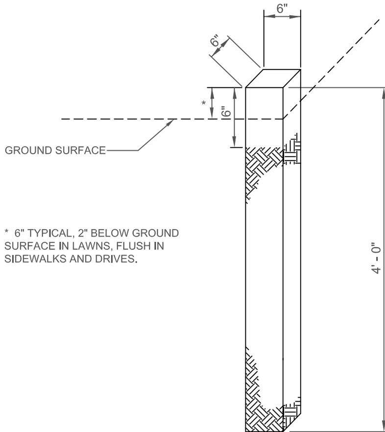
\* 6" TYPICAL, 2" BELOW GROUND SURFACE IN LAWNS, FLUSH IN SIDEWALKS AND DRIVES.
